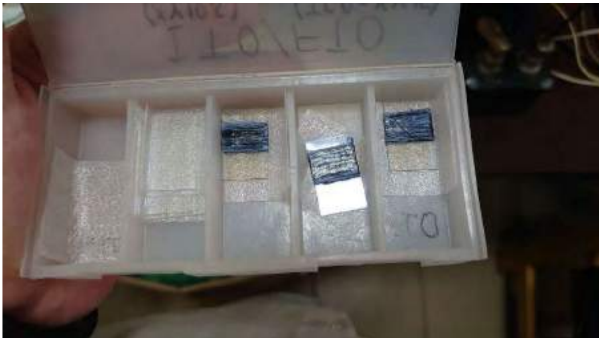
Рисунок А.6. Електроди після нанесення зберігаються у пластиковому чохлах для фотозахисту. На електродах тефлонова стрічка для обмеження робочої поверхні (струмопровідна сторона до верху), під електродами м'яка підкладка (контактує із скляною частиною електрода).
