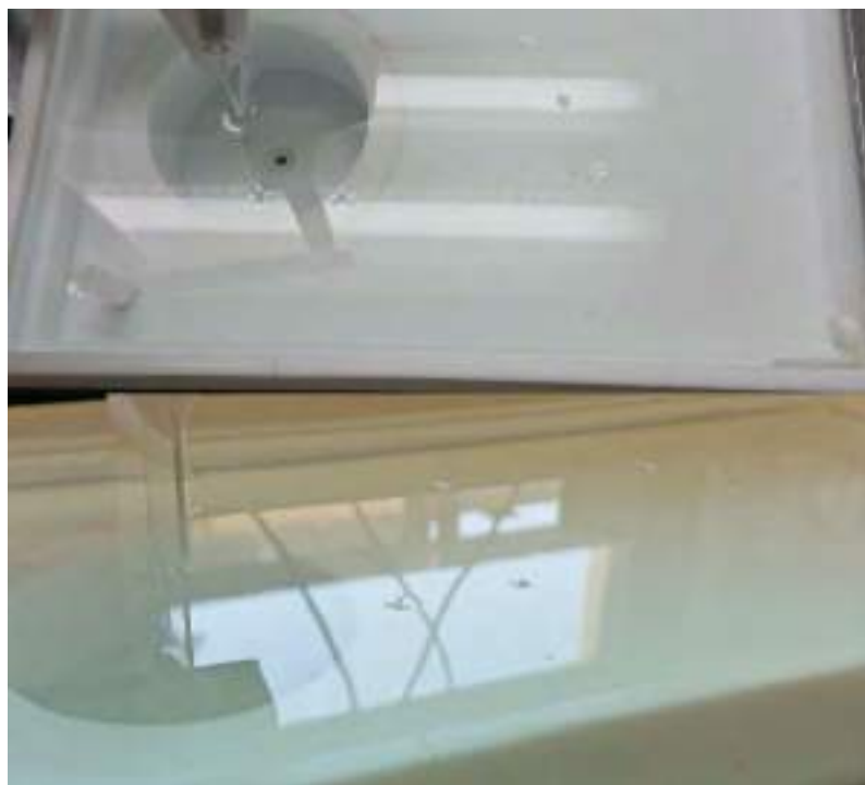
Рисунок А.4. Приклад колапсу плівки – кристалічні структури, які виникають після перевернення тиску колапсу.
