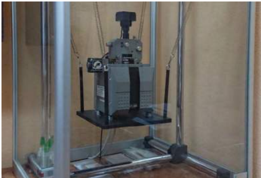
Рисунок А.12. Атомно–силовий мікроскоп (AFM) NT–206, Microtestmachines, Co.
