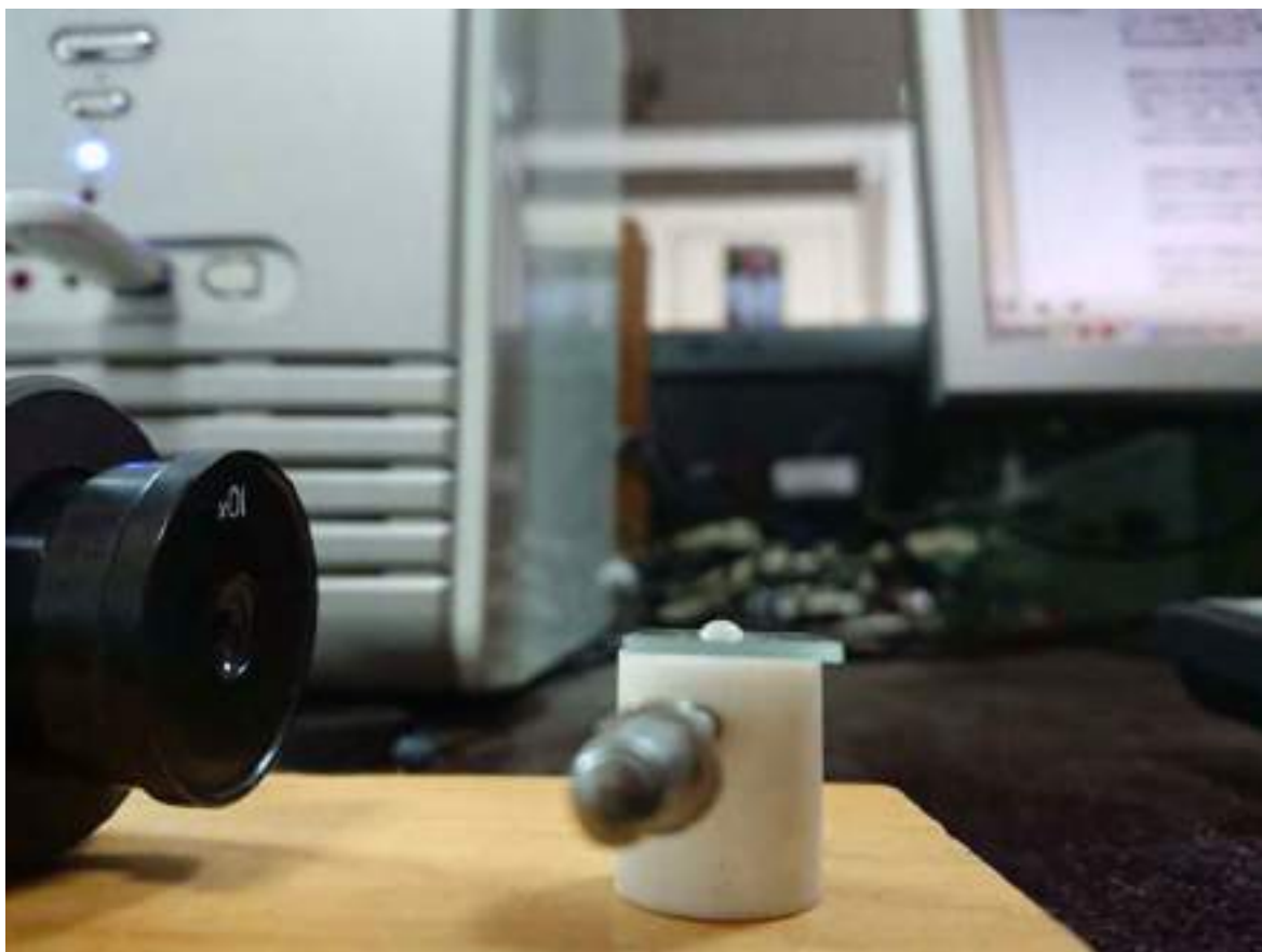
Рисунок А.8. Прилад для фотографування крапель для визначення крайового куту змочування – метод сидячої краплі.
