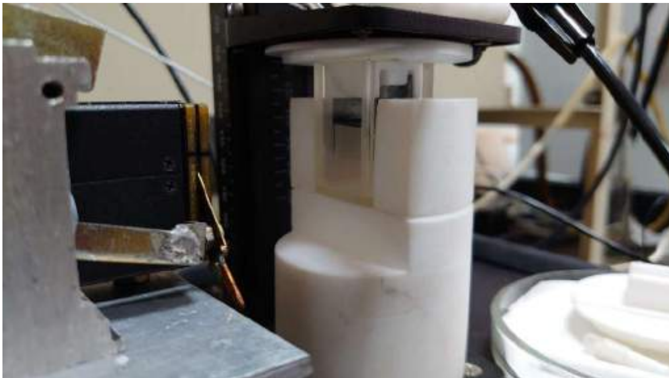
Рисунок А.29. Електрохімічна комірка: спектрофотометрична комірка з розчином ДФА у воді, робочий електрод – сенсор на основі ІТО (зліва), протиелектрод – скловуглець (справа), електрод порівняння – хлоридсрібний (посередині); фотоелектронний помножувач із рухомою кареткою (у експерименті ставиться впритул до комірки у виїмку у фторопластовий тримач); газова трубочка для барботування (чорна в правій верхній частині).
