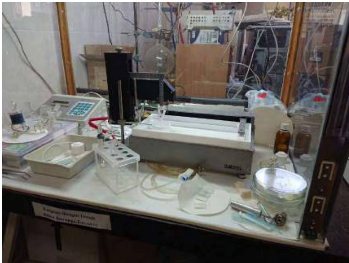
Рисунок А.2. Ванна Ленгмюра-Блоджетт LT-103 (LB trough LT-103) від компанії Microtestmachines Co.
