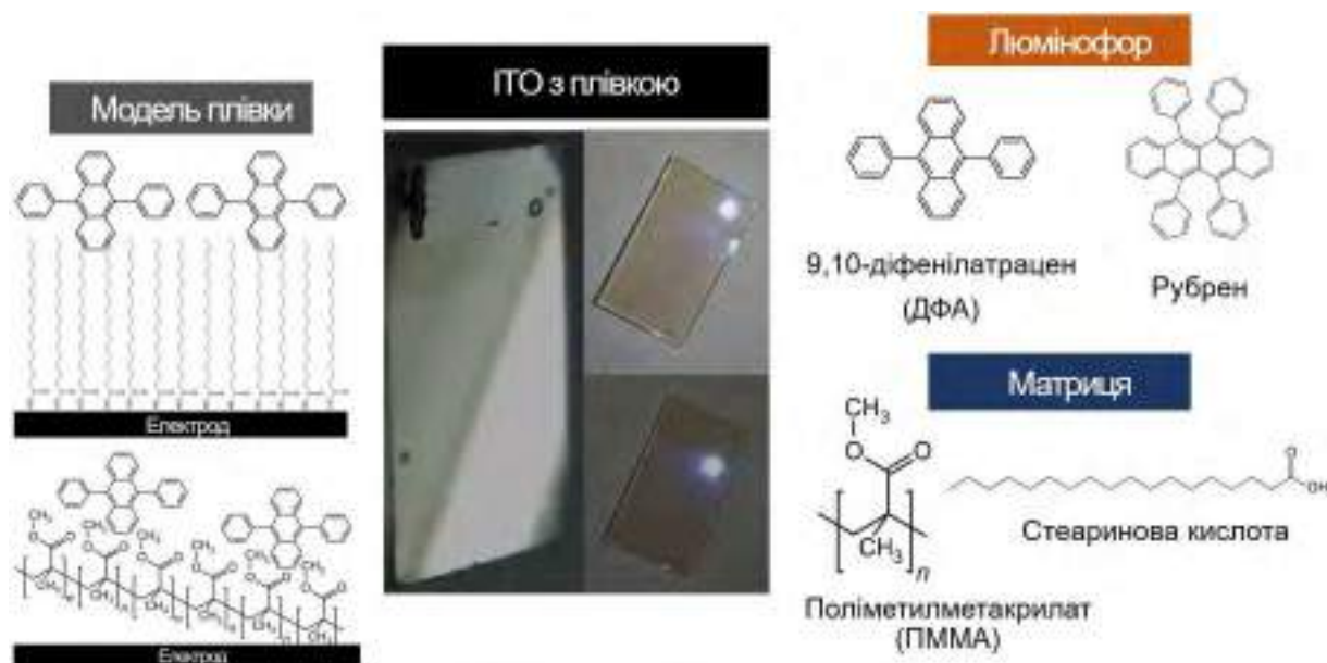
Рисунок 2.19. Сенсори на основі ІТО, люмінофори, матриця та модель плівки.
